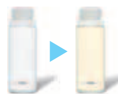
Colore dell'olio fresco di fabbrica Colore dell'olio dopo 10 anni d'uso
